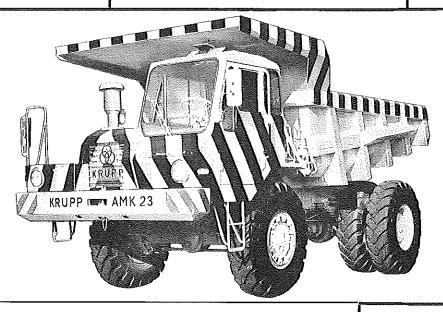
Diesel-Motor  $\cdot$  7 Zylinder  $\cdot$  2-Takt  $\cdot$  250 Ps bei 1850 U/min
